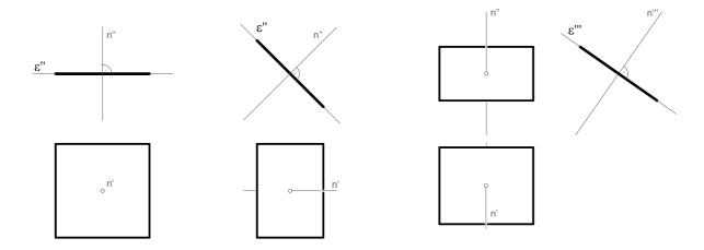
**<u>Fallgerade:</u>** Eine Gerade einer Ebene ε, die normal zu einer (1.) Hauptgeraden von ε ist, heißt Fallgerade.
