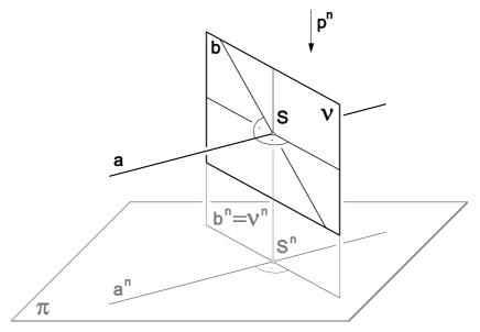
Orthogonalität zwischen Gerade und Ebene in speziellen Lagen:
